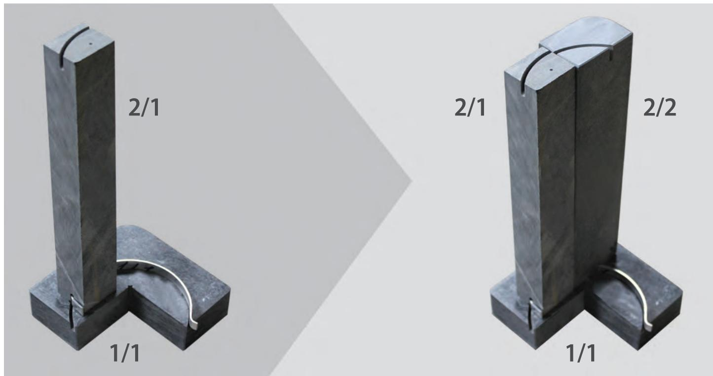
По мере установки деталей закрепляем их скобами.
